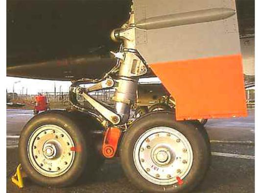
*L'exemple ci-dessous montre le train principal en position vol, la poutre est inclinée.*
