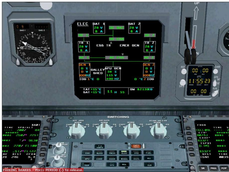
L'ECAM (Electronic Centralized Aircraft Monitoring) est l'écran placé au milieu du cockpit, accessible par les deux pilotes. Il pourra afficher le menu contextuel attaché aux aérofreins. On pourra par exemple y trouver un synopsis représentant la position des différents aérofreins et/ou spoilers.
